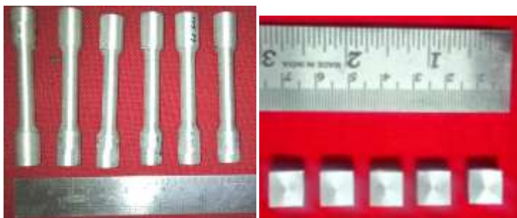
Fig. 2.Tensile test specimen, Fig.3.Hardness specimen
