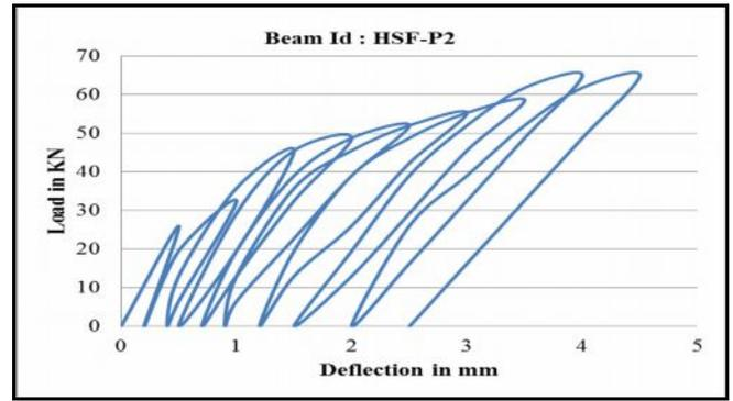
Fig. 4(d) Cyclic Response of HSF-P2 Beam
